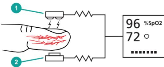
A oximetria processa estes sinais, separando os parâmetros invariáveis (espessura do tecido, cor da pele, intensidade de luz e sangue venoso) dos parâmetros variáveis (volume arterial e SpO<sub>2</sub>) para identificar a pulsação e calcular a saturação de oxigênio funcional.
