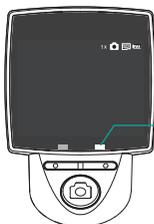
Durante a recarga da bateria a luz vermelha irá piscar constantemente. Após a recarga completa, a luz vermelha será substituída pela verde.
