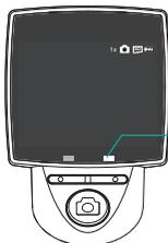
O status de bateria fraca é indicado através da luz vermelha intermitente.
