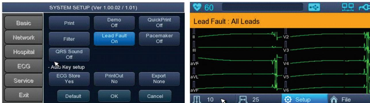
A seguinte mensagem para falha dos eletrodos será mostrada com os canais afetados:
