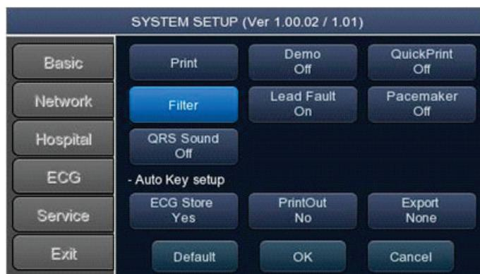
Após a seleção, abrir a tela com as opções do Filtro, . Use a tecla rotativa ou a tela de toque para navegar e selecionar os itens de menu a serem editados. Após a edição, OK deve ser selecionado para aplicar o valor alterado.
