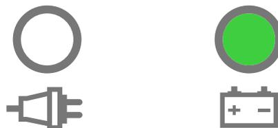
Se a energia da bateria for insuficiente (8.6V ou inferior), os alarmes soarão, e a mensagem "Bateria Baixa" será exibida na tela LCD por alguns minutos antes que energia para o equipamento seja desligada automaticamente. Neste caso, a energia de CA deverá ser imediatamente ligada ao equipamento para usá-lo.
