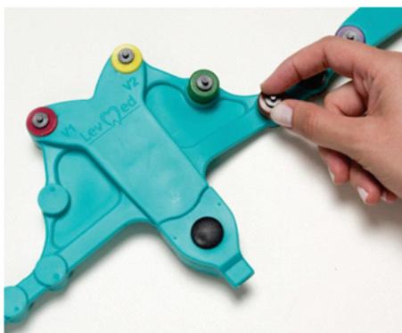
3. Conecte o cabo paciente nos parafusos do cinto extensor através do adaptador tipo banana, conforme a imagem:
