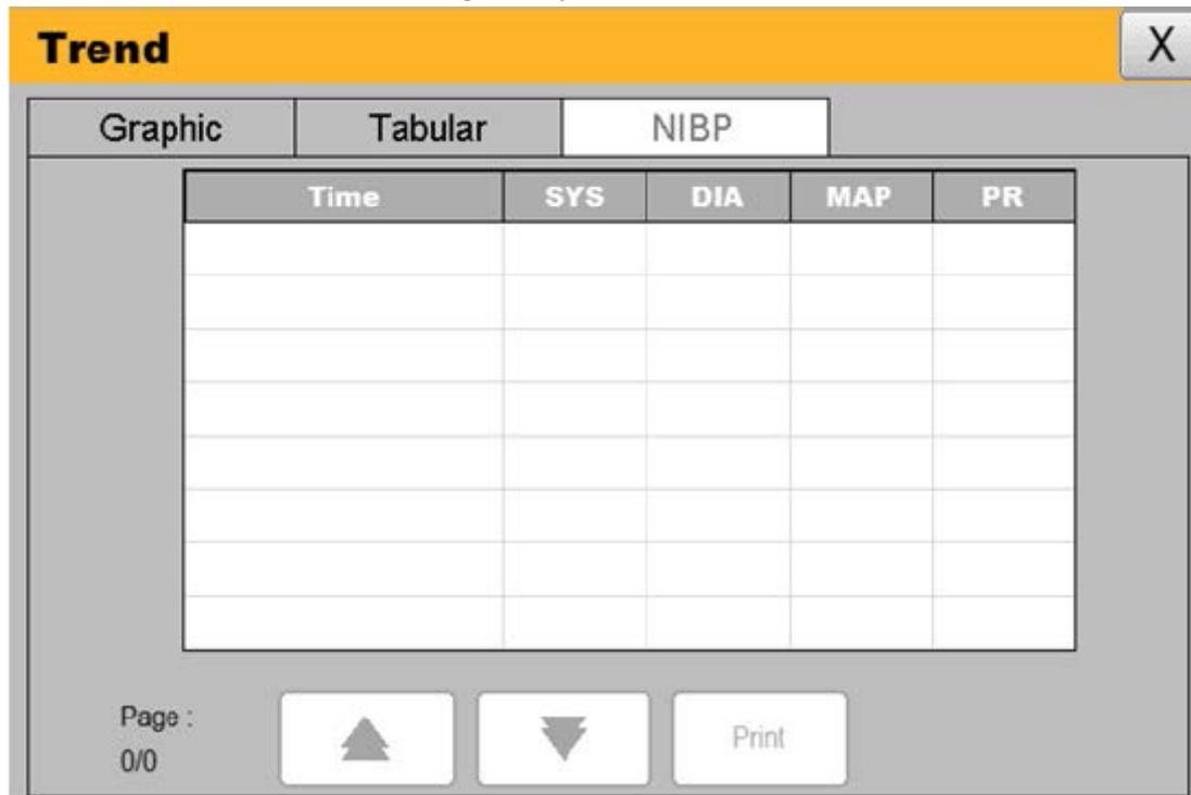
Esta janela mostra o tempo de medição da pressão arterial não invasiva, pressão arterial sistólica "SYS", pressão arterial diastólica "DIA", pressão arterial média "MAP" e frequência de pulso "PR". O monitor pode armazenar 1000 conjuntos de medidas de PNI no total.
